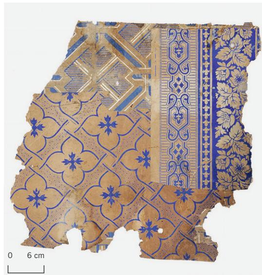
Abb. 103: Im Uhrzeigersinn von links oben: Blau-weiße Flechtmustertapete, Fnr. 1437.182.5, Streifentapete, Fnr. 1437.182.3, Tapete mit Vierblattmuster, Fnr. 1437.182.2. Flechtmustertapete und Streifentapete: 1830–1880, ungrundiertes Endlospapier, vermutlich Handdruck, zwei bzw. eine Farbe. Tapete mit Vierblattmuster: 1850–1970, ungrundiertes Endlospapier, vermutlich maschineller Zylinderdruck, eine Farbe. Alle aus: Baar, Rathausstrasse 6/8, Raum 2.4, Deckentapeten. M. 1:6.
