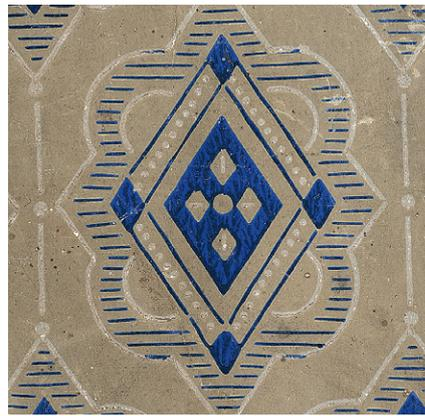
Abb. 45: Mit zwei Farben von Hand bedruckte Tapete. Die Wellen, die in der blauen Farbe vorkommen, können im Handdruck beim Abheben der Druckplatte entstehen. Tapete mit blau-weißen Fliesen und Rhomben, Fnr. 1437.189.4. Baar, Rathausstrasse 6/8, Raum 4.4.
